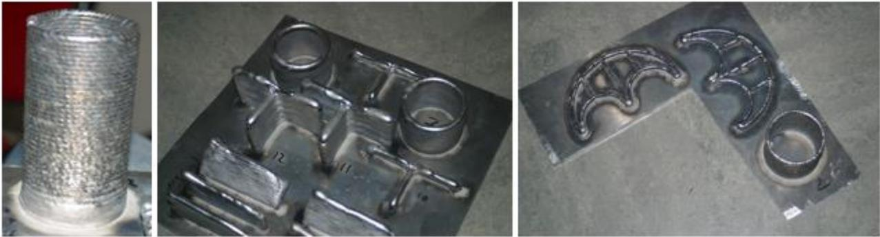
Figure 6: Exemple de pièces en aluminium réalisées avec la Cellule WAAM CMT
