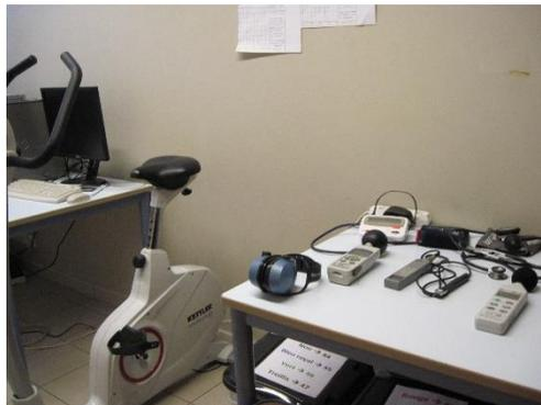
La maquette repose sur des capteurs IIoT caractérisant les ambiances et conditions de travail, ceux pouvant être portés par l'opérateur ou non. On trouve par exemple des capteurs de bruit, de température, d'éclairage, de polluants atmosphériques, de localisation gps, de grandeurs physiologiques (cardio-fréquencemètre, dépense énergétique) ...
