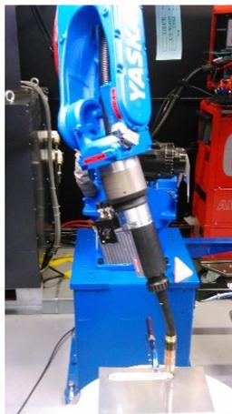
Figure 5 : Cellule de soudage robotisée – WAAM CMT
