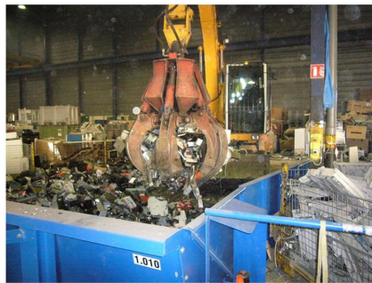
Figure 2. Préparation au pré-broyage des DEEE (en vue du tri automatique des matériaux) en développement chez les recycleurs, au détriment du démontage manuel. (© EcoDEEE)
